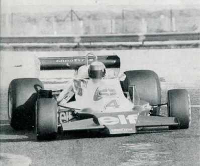
La Tyrrell 008 (a sinistra con alla guida Stewart) ha evidenziato qualche problema di torsione ed una certa fragilità agli attacchi dei puntoni, che pure erano stati rinforzati. Secondo Peterson, che ha seguito per qualche giro Depailler, la 008 è anche molto sovrasterzante. E se lo dice lui... A destra, il largo spazio fra abitacolo e DFV nella parte centrale della Tyrrell 008: sarebbe il posto ideale per piazzare lo scambiatore di calore del Turbo Renault... E' probabile, infatti, che ben presto la Tyrrell usi il V6 sovralimentato
