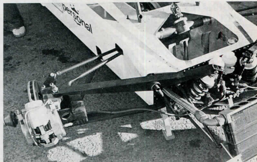
A sinistra, la sospensione posteriore con un solo puntone di reazione e cuscinetti di grande diametro nei portamozzi. Qui sopra, la sospensione anteriore che ricorda quella della 312 T2
